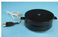
36-nji surat. Tejribehana elektrik plitkasy
