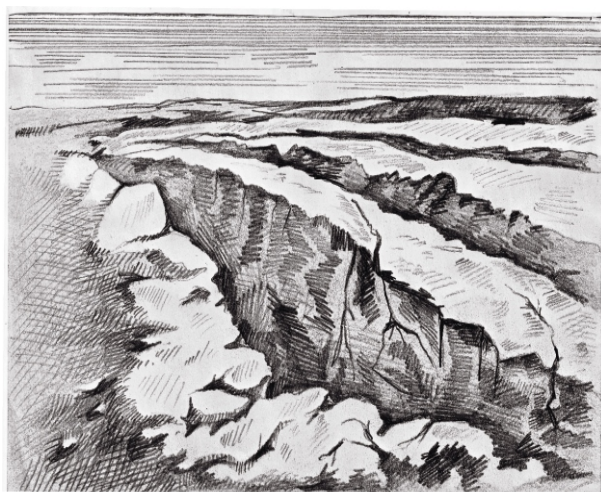
26-njy surat. Kanalyň boýunda yzgarlap çökme jaýryklary
